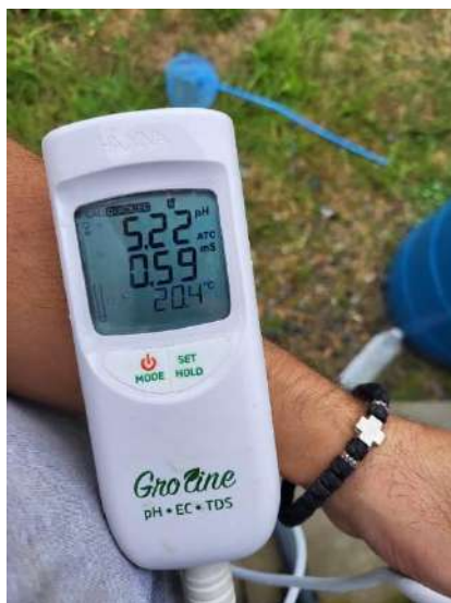
Слика 5. Мерење параметара воде за наводњавање (Фото: Срђан Савић)
